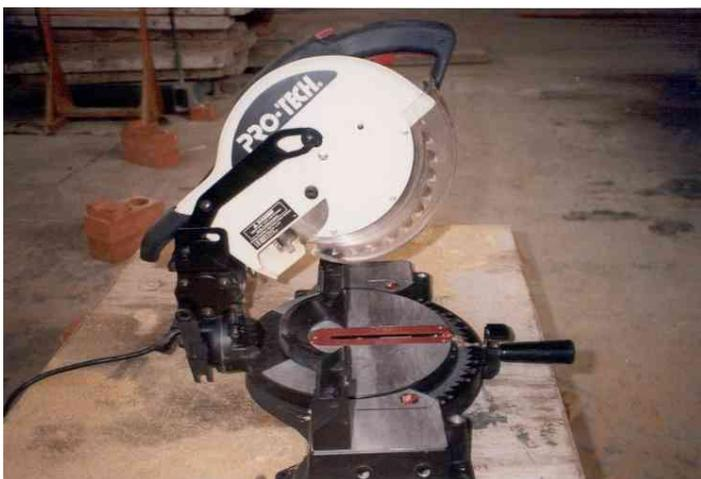
Para realizar los cortes de todas las probetas se utilizó una Acolilladora marca PRO-TECH, con la cual se realizaron los diferentes cortes en la guadua.
