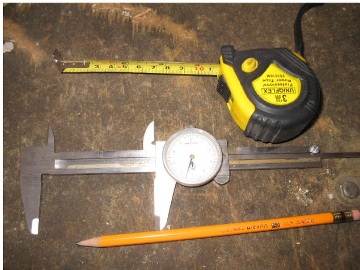
Medición de la longitud, diámetro y espesor de las probetas de la fuente Armenia. Se tomaron 3 medidas de la longitud, 3 del diámetro superior e inferior separados
