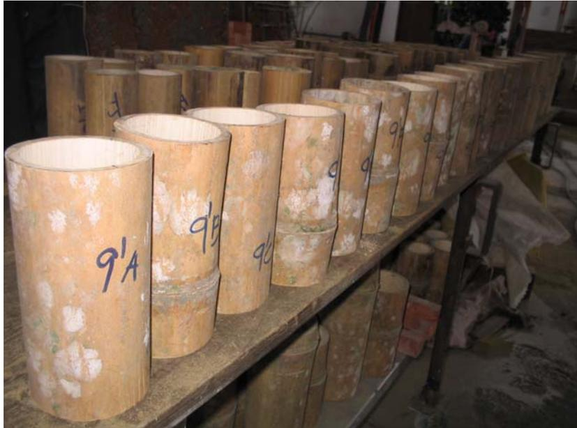
Medición de la longitud, diámetro y espesor de las probetas de la fuente Tierradentro. Se tomaron 3 medidas de la longitud, 3 del diámetro superior e inferior separados 120 grados una medida de la otra y se tomaron 3 espesores en la parte superior e inferior.
