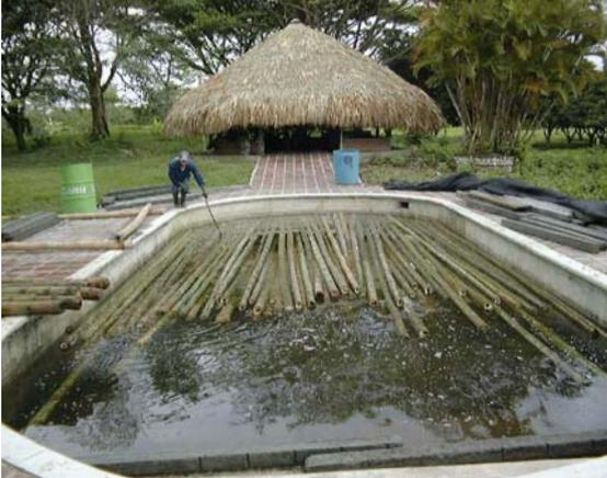
Sumergir Guadua es una técnica usada con frecuencia, se sumergen los tallos en agua circulante de 4 a 12 semanas, fermentando y extrayendo los almidones y azucares de la guadua.
