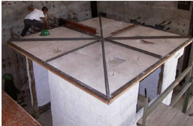
Foto 3. Detalle diafragma semirrígido
