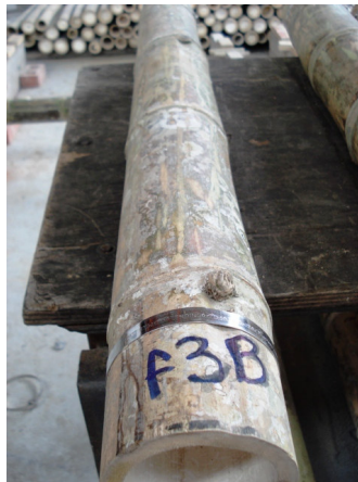
Fotografía 8. Nomenclatura y ubicación de zuncho metálico
