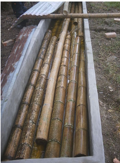
Fotografía 5. Tallos sumergidos en solución de boro
