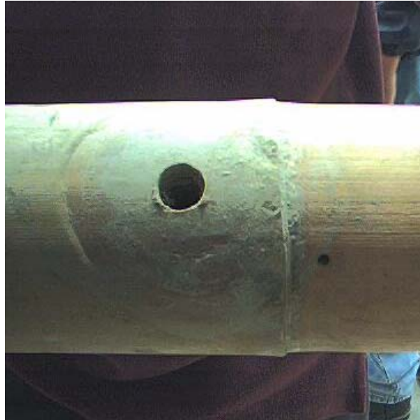
FOTO 41 DETALLE COMPRESION PERPENDICULAR A LAS FIBRAS
