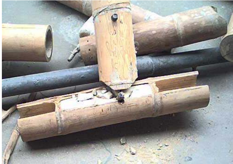
FOTO 32 DETALLE ROTURA DEL MORTERO DE RELLENO
