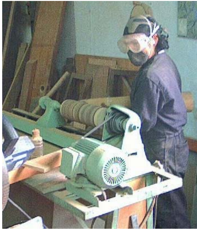
FOTO 45 REALIZACION DEL BOCA PESCADO
