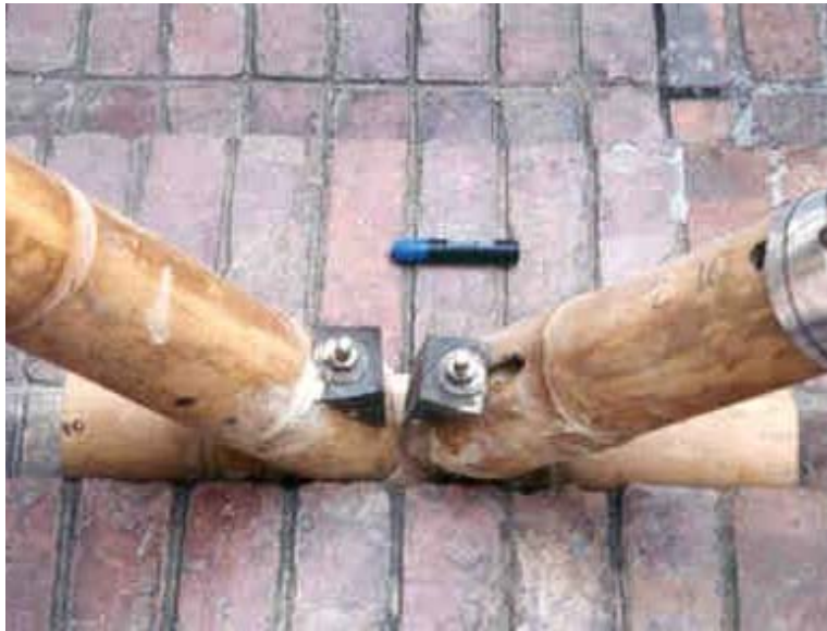
FOTO 38 VISTA SUPERIOR FALLA SVM 60°
