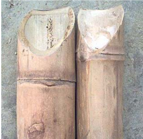
FOTO 44 COMPARACION BOCA PESCAO TRADICIONAL Y CON EL DISPOSITIVO DRILL BP
