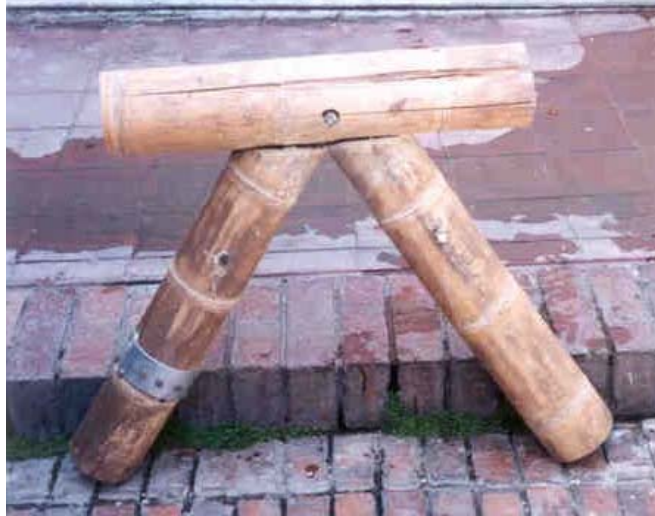
FOTO 40 FALLA UNION DG 60°
