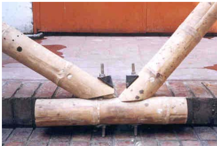
FOTO 33 FALLA UNION SVM 45°
