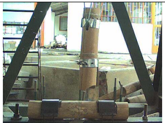
FOTO 29 FALLA UNION SC 90° TENSIÓN
