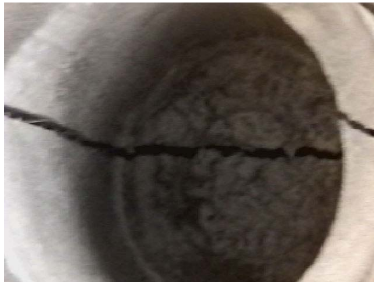
FOTO 31 VISTA LATERAL DE FALLA DG 90° TENSION
