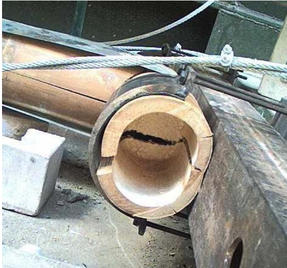
FOTO 23 FALLA SC 90° COMPRESION
