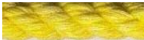
Foto No. 29. Cuerda de polipropileno de 3/16" marca ZUBI-OLA
