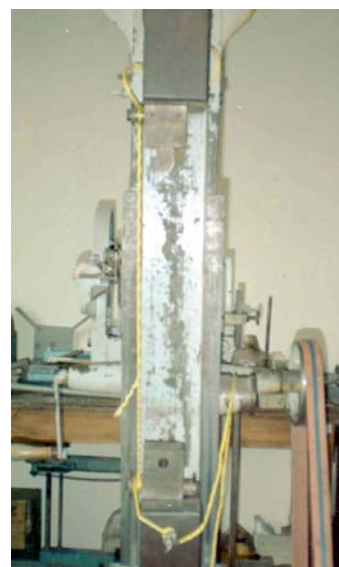
Foto No. 30. Ensayo a tensión de cuerda de polipropileno.
