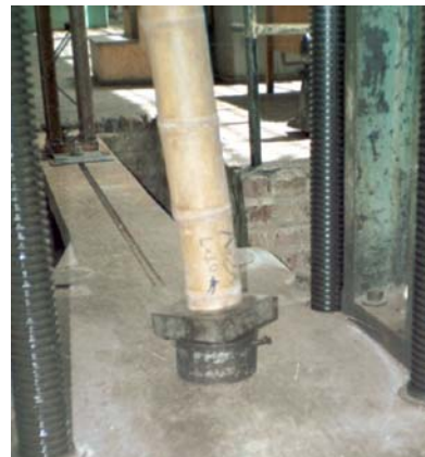
Foto No. 24. Detalle de apoyo con rótula para ensayo de probetas tipo A
