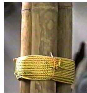
Foto No. 31. Unión tipo uno en el centro de la longitud de la probeta
