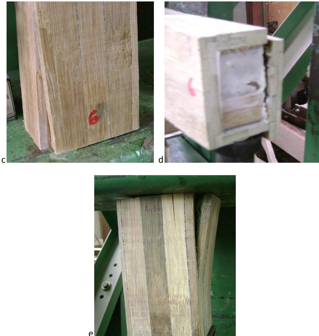
**Gráfica 8.** a) Desprendimiento de tapa en unión tipo lámina, b) Desprendimiento de tapa en unión tipo lámina, c) Desprendimiento tapa unión tipo ángulo, d) Desprendimiento de tapa en unión tipo ángulo.
