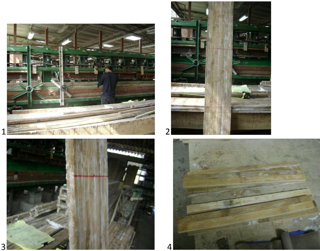
GRÁFICA 2. 1. Prensado de los tableros y cajones, 2. Tableros (se puede observar la longitud de las secciones, ya sea para viga o columna), 3. Ancho de tableros, 4. Laterales y tapas de los cajones.
