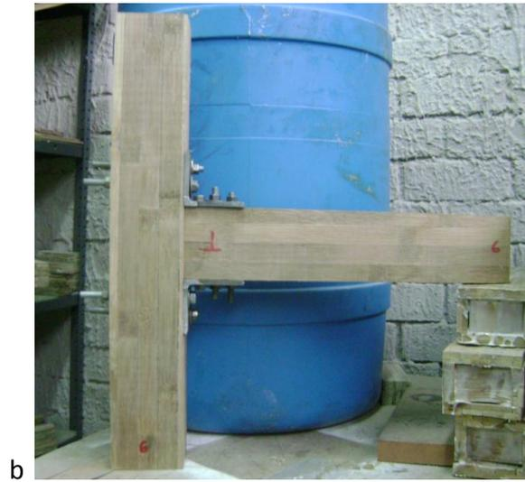
**Gráfica 5.** Montaje unión tipo ángulo. a) Montaje teórico de la unión tipo ángulo, b) Unión real de la unión tipo ángulo.
